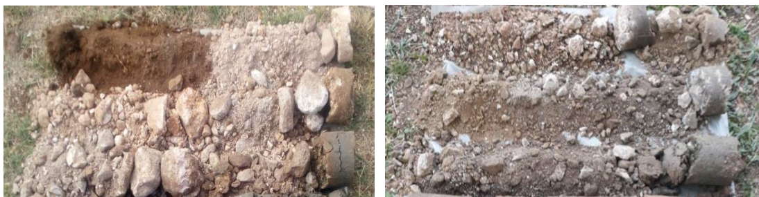
Slika 7. Recentne tvorevine – sredina 1 iz istražnih bušotina B-3 i B-2 (slika desno)
