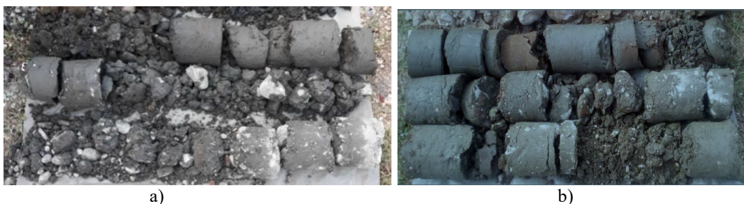
Slika 8. Eluvijalni sedimenti iz istražnih bušotina B-4 (a); B-5 – interval 3,0-6,0 m (b)
